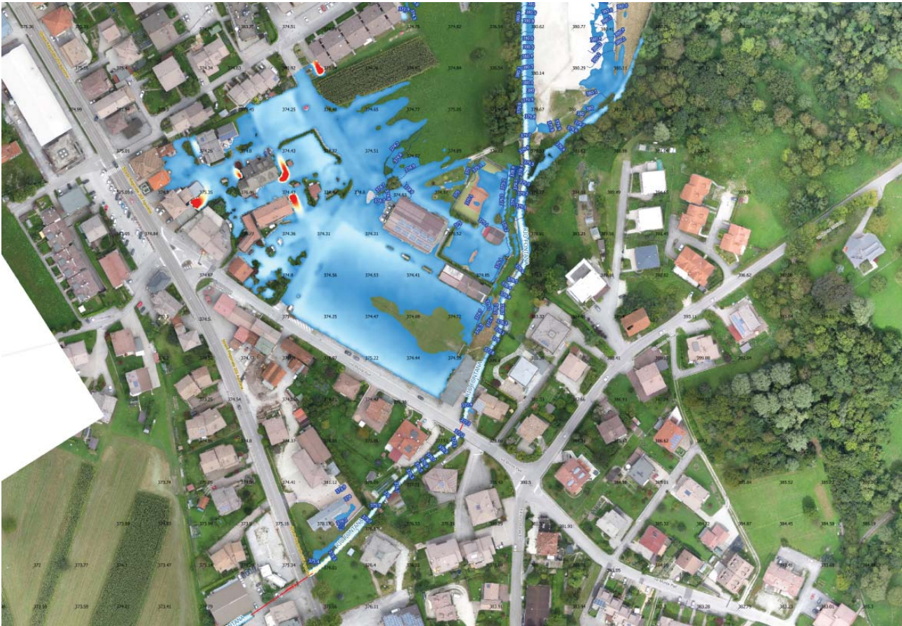
Figura 11-29 – Stralcio dell'elaborato 3.2 – Aree allagate in assenza di ostruzioni sugli attraversamenti della SR 203 "Agordina"
