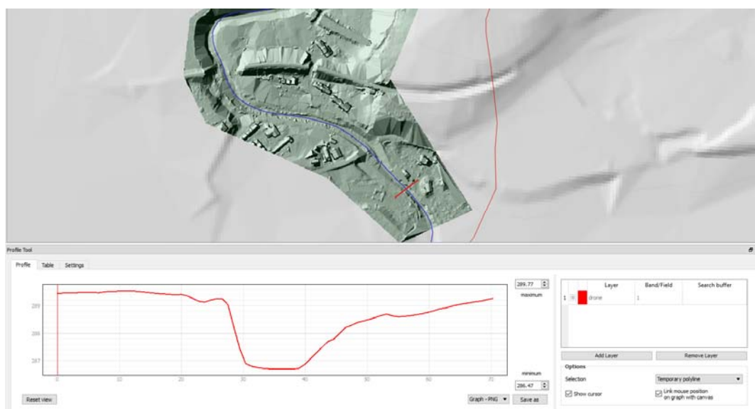
Figura 9-6 – Geometria della sezione del Torrente Gresal alla chiusura del Bacino Idrologico.
